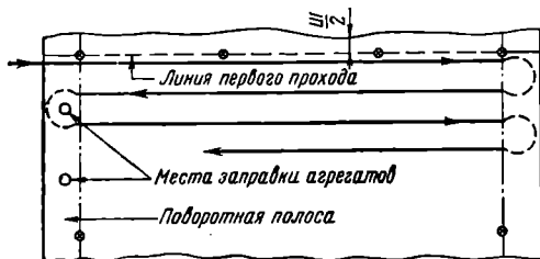
Рис. 18. Схема разметки поля и движения агрегата при внесении минеральных удобрений челночным способом.
