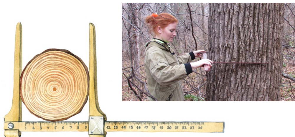
Рис. 23. Измерение диаметра дерева мерной вилкой
