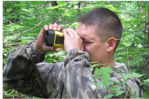
Рис. 28 Измерение высоты дерева ультразвуковым (слева) и лазерным (справа) высотомерами
