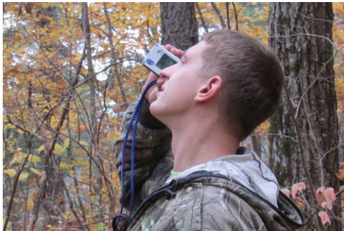
Рис. 28 Измерение высоты дерева ультразвуковым (слева) и лазерным (справа) высотомерами
